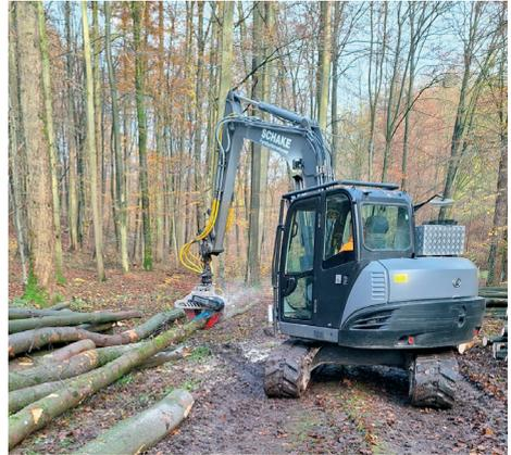
Der Bagger mit Sägevorrichtung ermöglicht es, das Spannungsholz aus Windwurf bodenschonend und vor allem sicher zu bergen.
